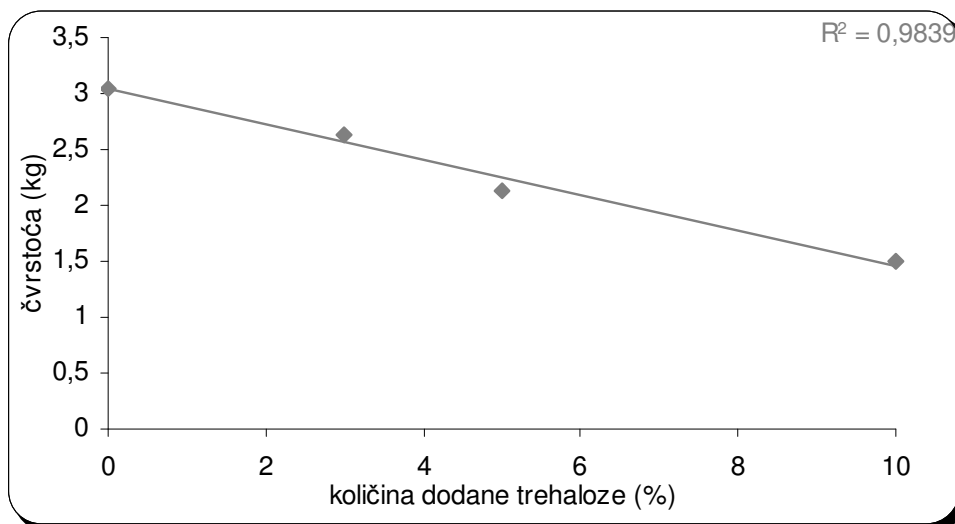
Slika 33. Ovisnost čvrstoće (mjerene Kramer-ovim nastavkom) o količini trehaloze u evaporiranim uzorcima paste od jagode
