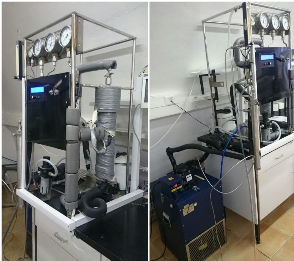
Slika 9. Uređaj za superkričnu ekstrakciju (PTF Osijek)
