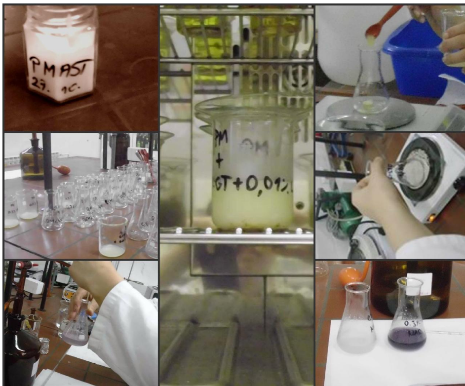
Slika 15 Kratki prikaz pripreme palmine masti za Oven test, Test oksidacijske stabilnosti na 98°C.
