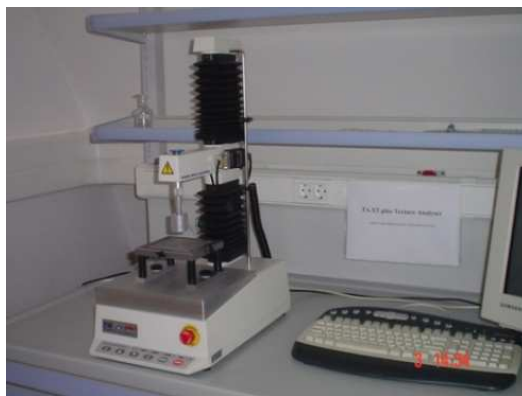
Slika 10 TA.XT2 Plus Texture Analyser (Zeko, 2013.)
