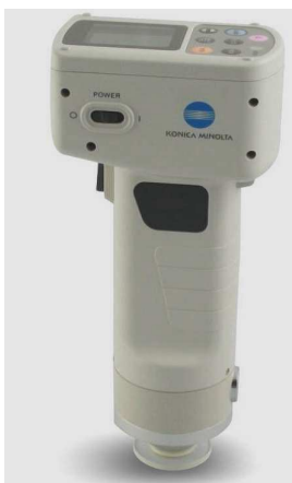
Slika 11 Kromametar Konica Minolta CR-300 (Gelemanović, 2013.)
