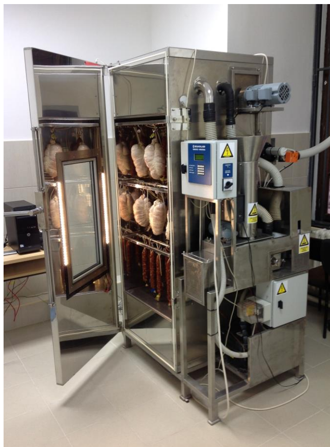
Slika 12 Automatizirana komora za zrenje kulena
