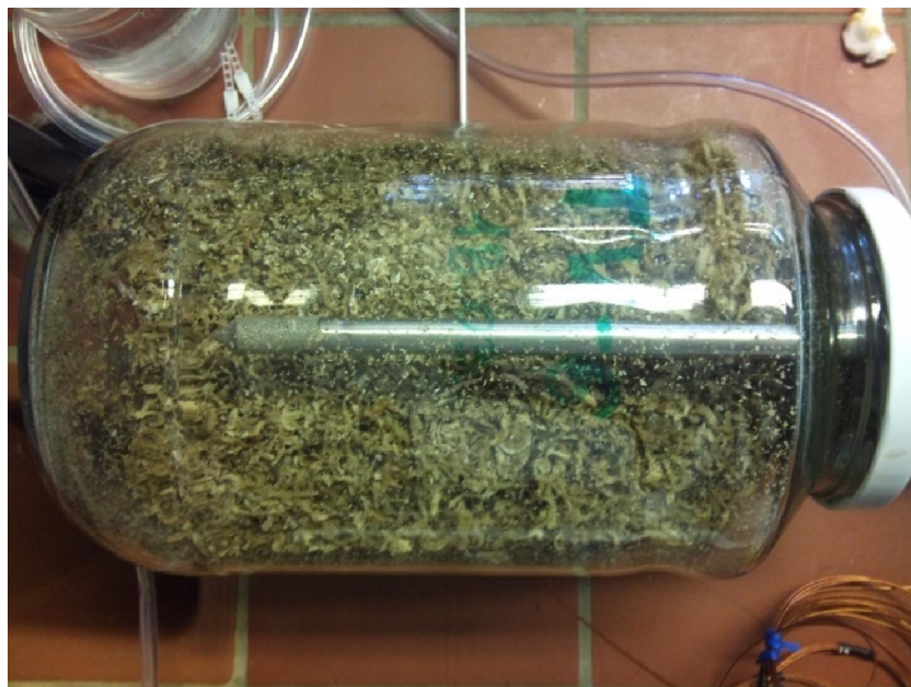
SLIKA 14 Repini rezanci nacijepjeni s T. versicolor u horizontalno-cilindričnom staklenom reaktoru
