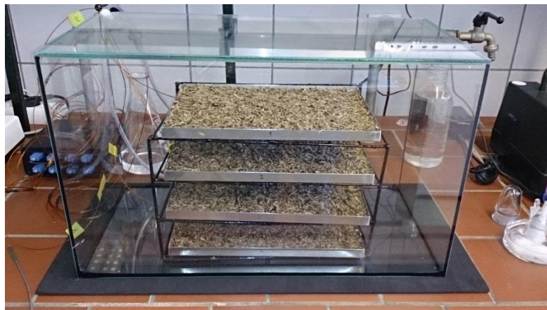
Slika 11 Laboratorijski bioreaktor s pliticama (TBR)
