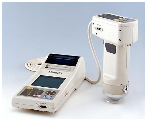
Slika 17 Kromametar Konica Minolta CR 400
