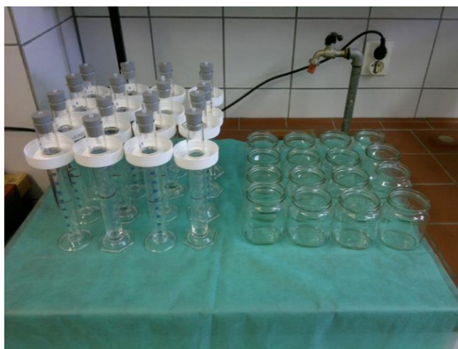
Slika 18 Aparatura za provedbu testa anaerobne razgradnje
