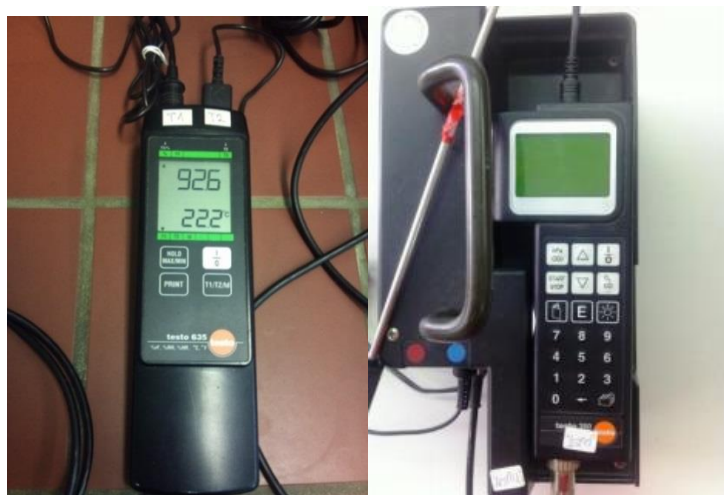
Slika 12 Uređaji za mjerenje temperature i relativne vlažnosti Testo 635 i Testo 350
