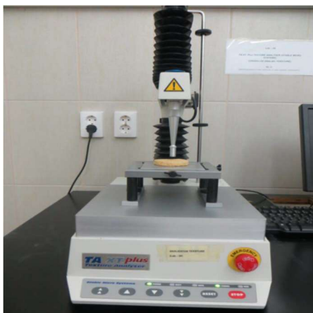
Slika 6. Analizator teksture TA.XT s opremom za prodiranje u uzorak
