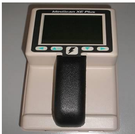
Slika 14 Kolorimetar Hunter-Lab Mini ScanXE
