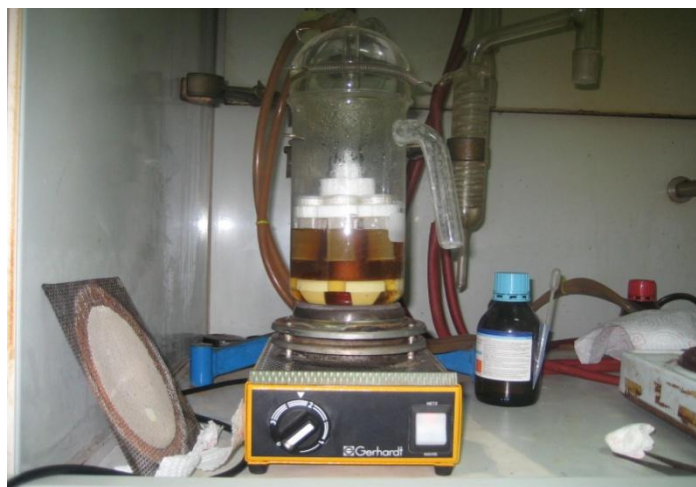
Slika 10 Kuhanje uzorka u razrijeđenoj sumpornoj kiselini (Jozinović, 2011.)
