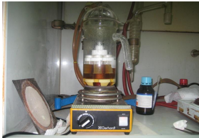
Slika 10 Kuhanje uzorka u razrijeđenoj sumpornoj kiselini (Jozinović, 2011.)
