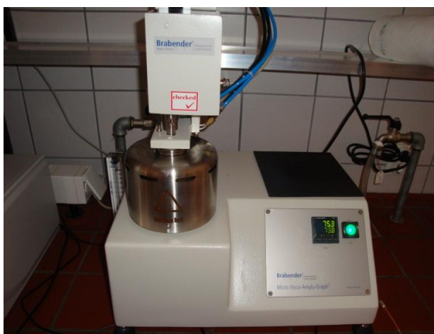
Slika 9 Brabenderov Mikro visko-analyzer (Jozinović, 2011.)
