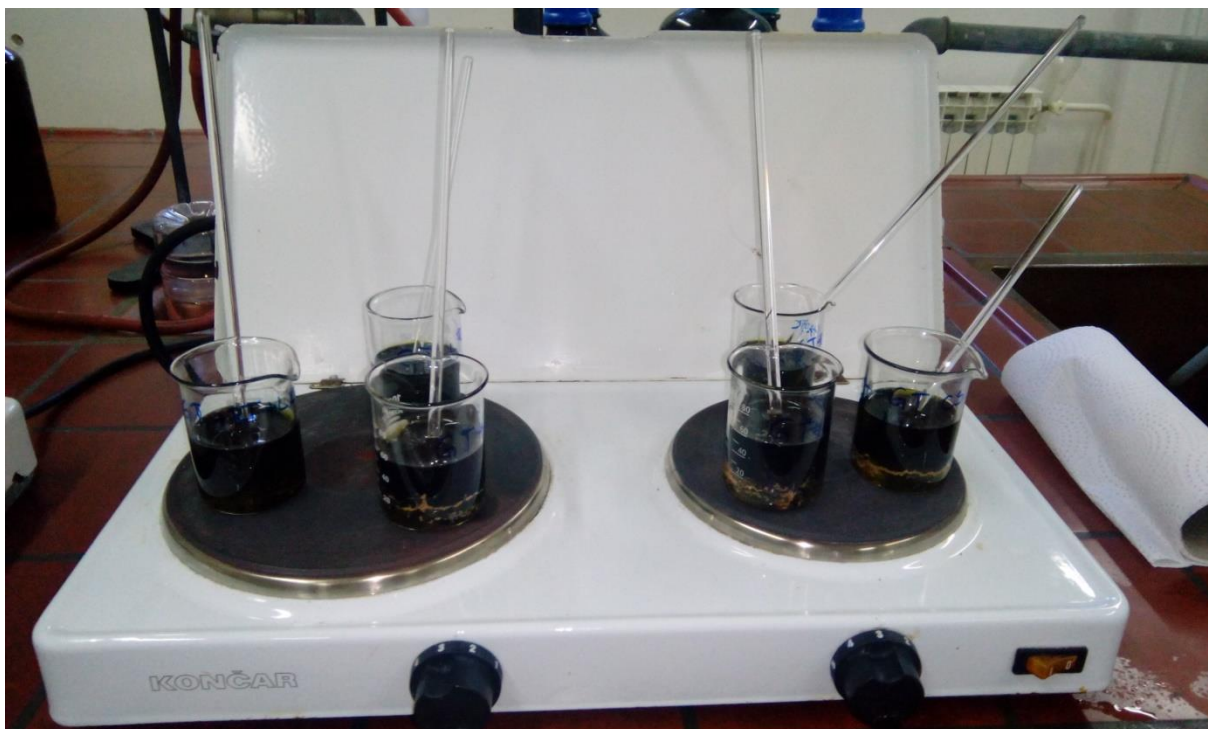
Slika 7 Zagrijavanje uzoraka i miješanje 30 min na 70-80 °C
