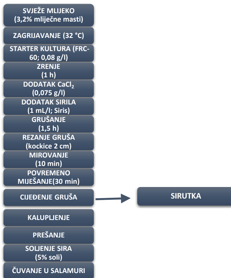
Slika 7 Blok shema proizvodnje Feta sira i dobivanje sirutke
