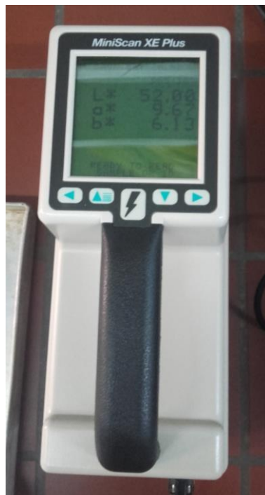
Slika 19 Kolorimetar Hunter-Lab Mini ScanXE
