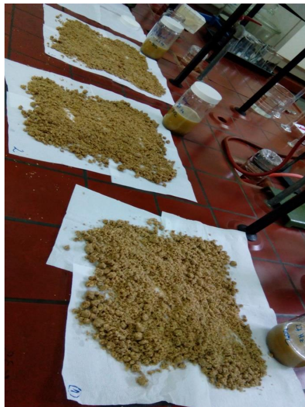
Slika 9 Dobivena pogača i sirovo ulje oraha
