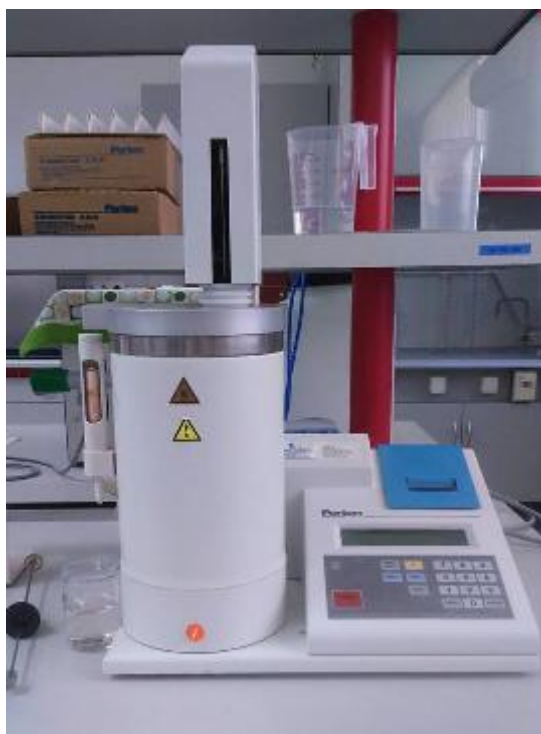
Slika 10 Uređaj po Hagbergu za određivanje broja padanja
