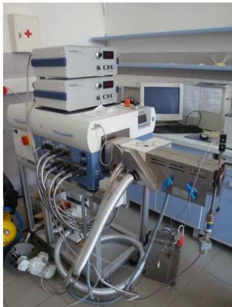
Slika 8 Laboratorijski jednpužni ekstruder Brabender 19/20 DN
