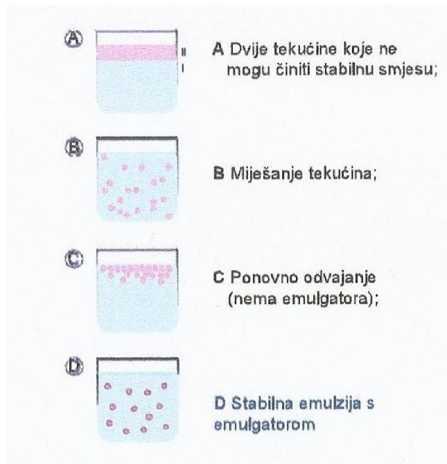
Slika 2 Shematski prikaz djelovanja emulgatora ( http://www.fkit.unizg.hr/ )
