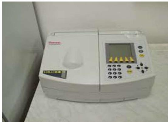
**Slika 4** Spektrofotometar - Spectronic Unicam, HelλOSy
