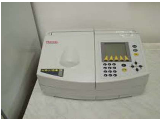
Slika 4 Spektrofotometar - Spectronic Unicam, HelλOSy
