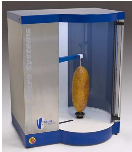
Slika 4. Prikaz uređaja za mjerenje volumena kruha Volscan Profiler
