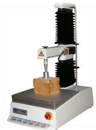
Slika 6. Prikaz uređaja za određivanje teksture TA.XT Plus
