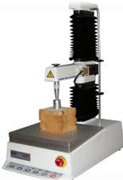
**Slika 13** Uređaj za određivanje teksturalnog profila uzorka TA.XT Plus TextureAnalyzer
