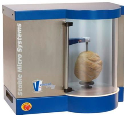
**Slika 12** Uređaj za mjerenje volumena kruha Volscan Profiler
