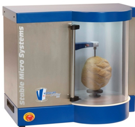
Slika 12 Uređaj za mjerenje volumena kruha Volscan Profiler
