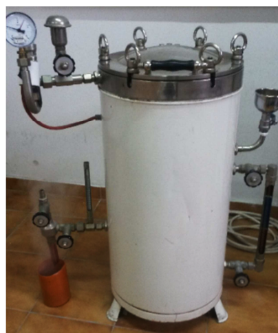
Slika 4. Autoklav TIP 7510945, Sutjeska, Beograd
