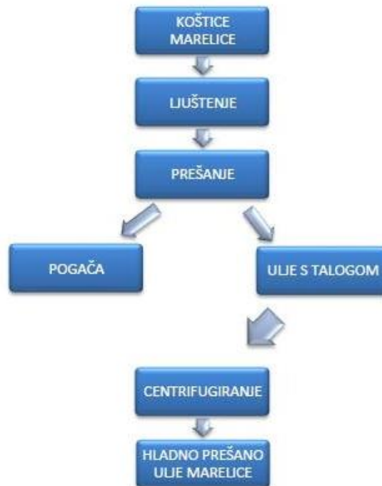
Slika 5. Blok shema tehnološkog postupka proizvodnje hladno prešanog ulja koštica marelice
