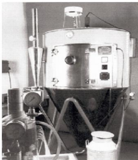
Slika 5 Laboratorijski model uređaja za sušenje raspršivanjem (Carić i Gregurek, 2003.)
