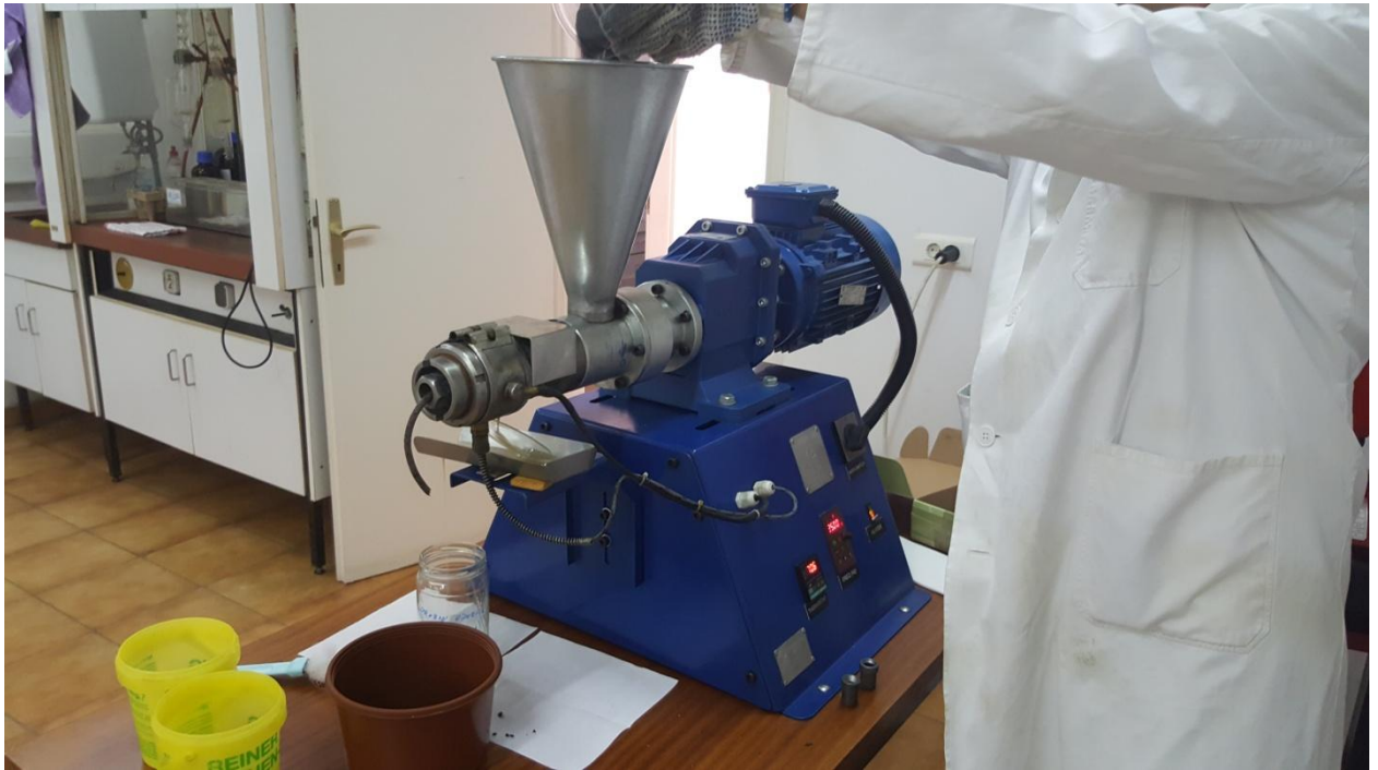
Slika 5 Laboratorijska kontinuirana pužna preša
