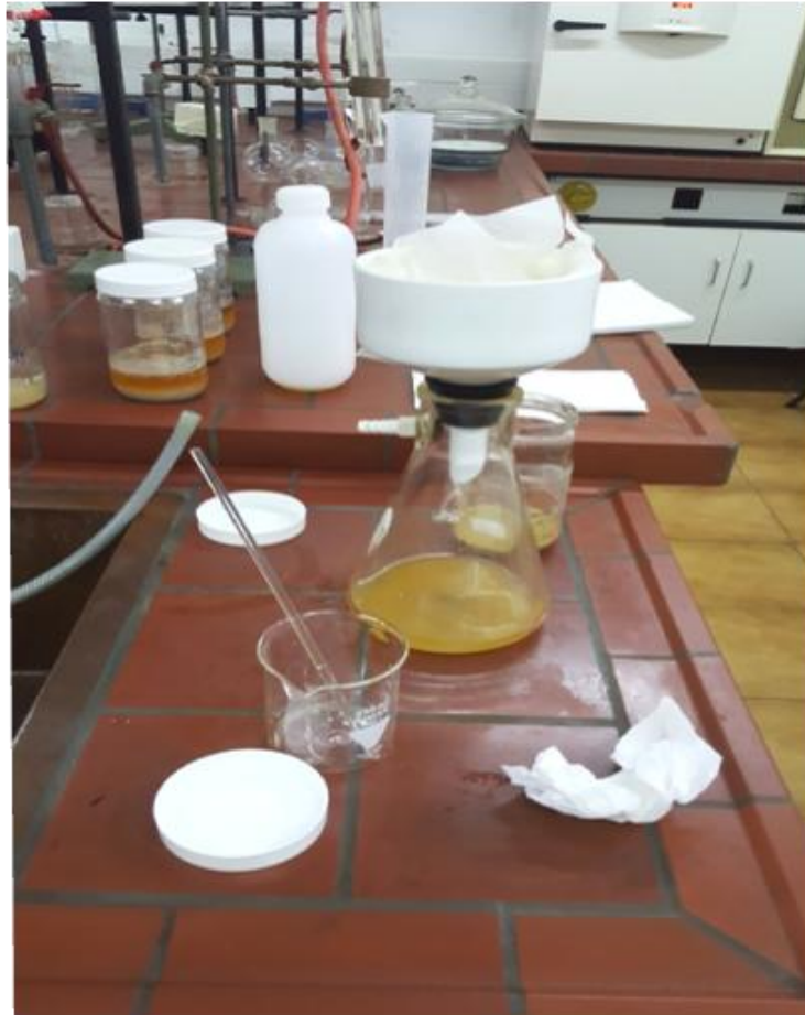
Slika 6 Vakuum filtracija sirovog ulja i proizvodnja hladno prešanog makovog ulja
