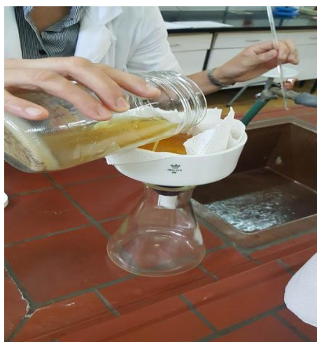
Slika 9. Vakuum filtracija sirovog ulja
