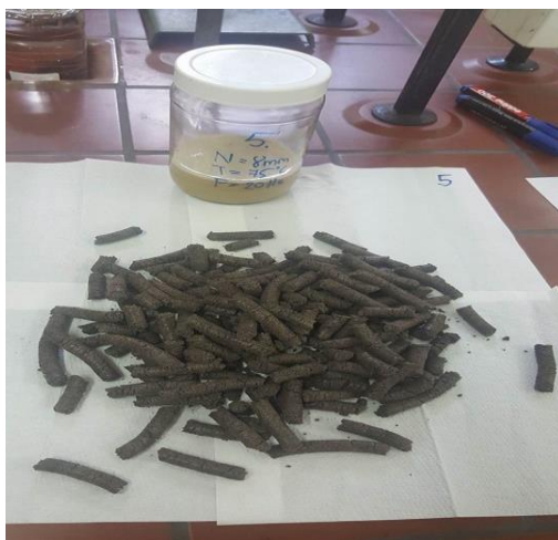
Slika 8. Produkti prešanja: pogača i sirovo ulje
