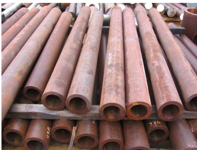
Slika 3. Cijevi zahvaćene korozijom
