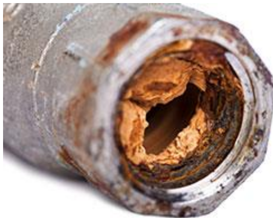
Slika 2. Pojava kamenca u cijevima uslijed prijenosa topline
