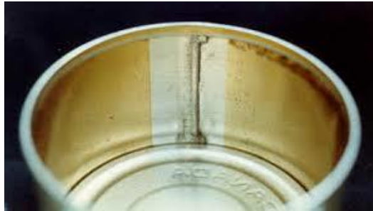
Slika 7 Korozija omotača limenke
