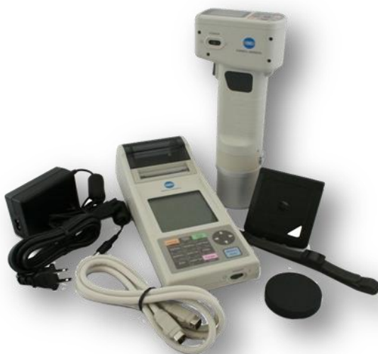
Slika 15. Uređaj za određivanje boje (Konica Minolta Chroma Meter CR-400) (web 9)
