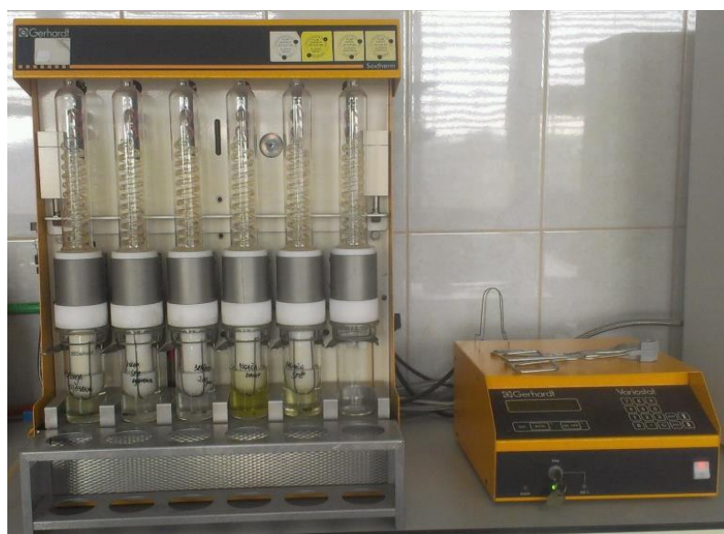
Slika 5 Soxterm ekstrakcijski uređaj
