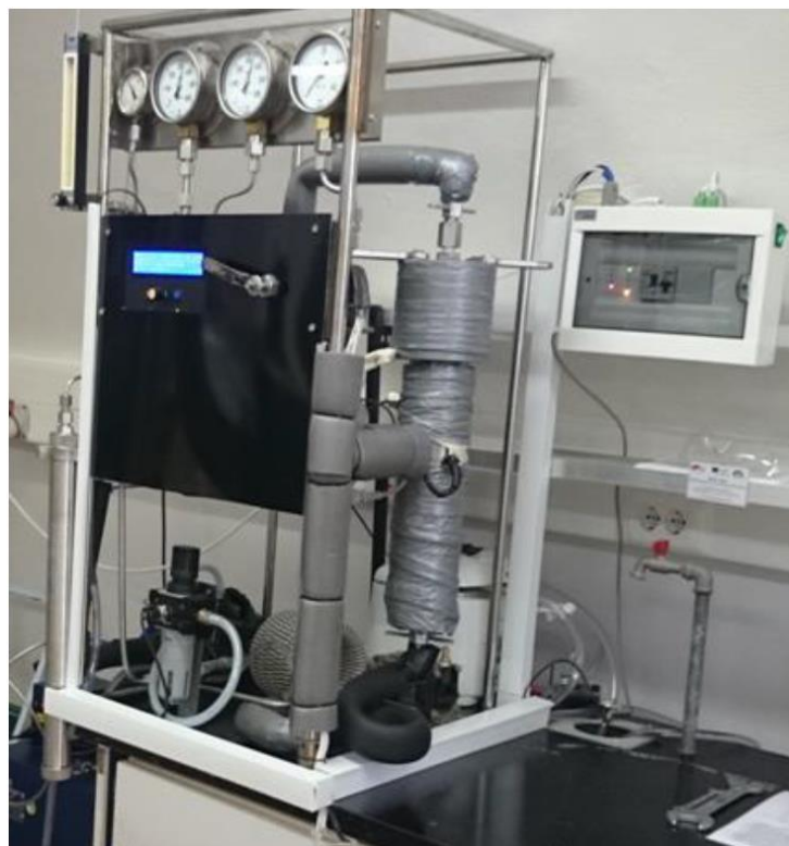
Slika 7 Uređaj za superkričnu ekstrakciju (Aladić, 2015)
