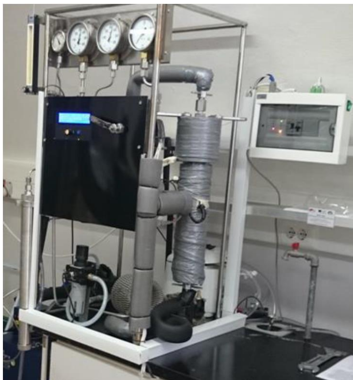
Slika 7 Uređaj za superkritičnu ekstrakciju (Aladić, 2015)
