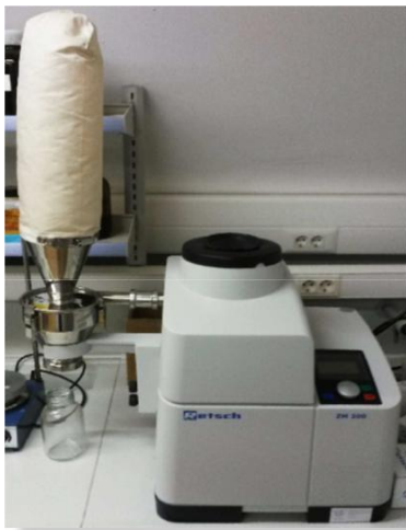
Slika 3. Ultracentrifugalni mlin Retsch ZM200
