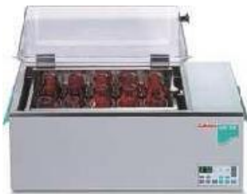
Slika 5. Vodena kupelj za ekstrakciju s tresilicom (Julabo SW-23)
