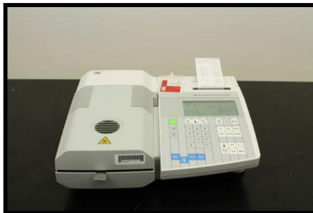
Slika 6 Analizator vlage (HR-73, Mettler Toledo)
