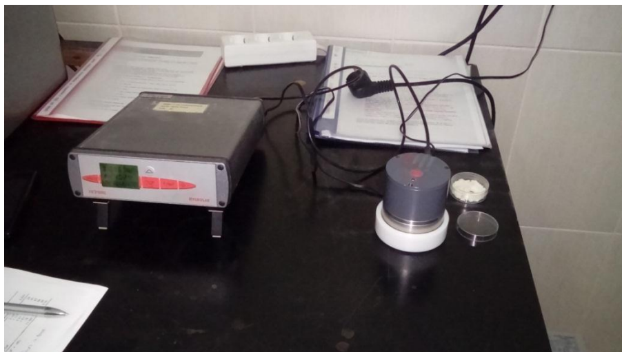
Slika 16 HygroLab 3 (uređaj za određivanje aktiviteta vode)
