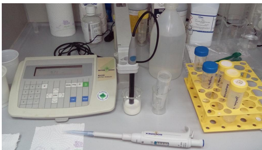
Slika 7 Dodavanje otopina kiselina u mlijeko i mjerenje pH vrijednosti mlijeka
