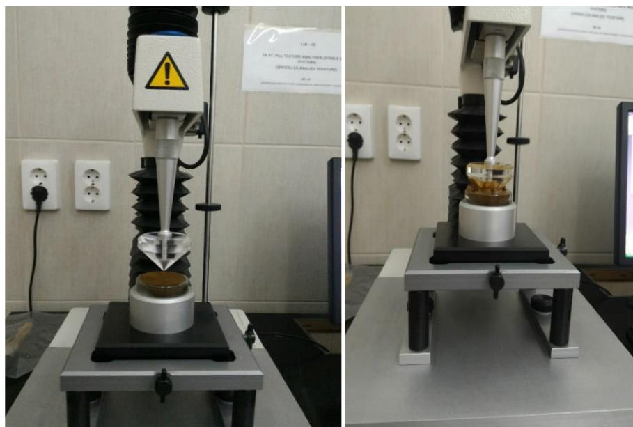
Slika 22 Prikaz prodiranja nastavka za teksturu konusnog oblika
