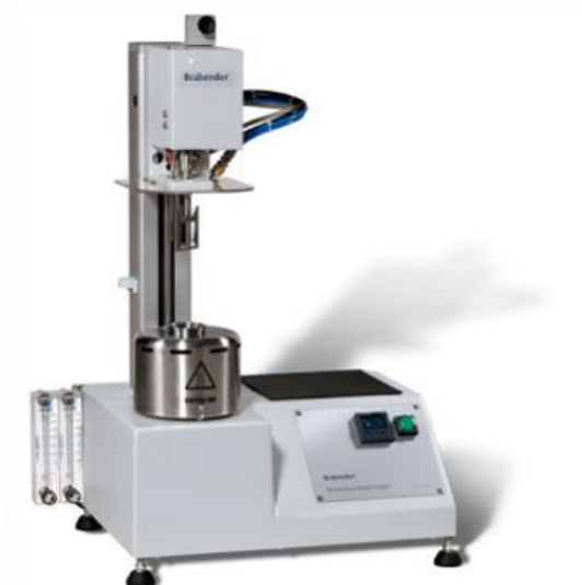
Slika 11 Brabenderov Mikro visko-amilograf (Jozinović, 2015)
