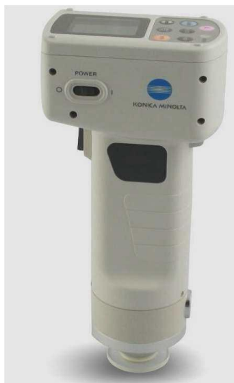
Slika 10 Kromametar Konica Minolta CR-300 (Gelemanović, 2013)
