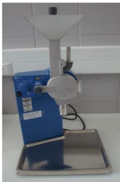
Slika 9 Laboratorijski mlin IKA MF10 (Jozinović, 2015)
