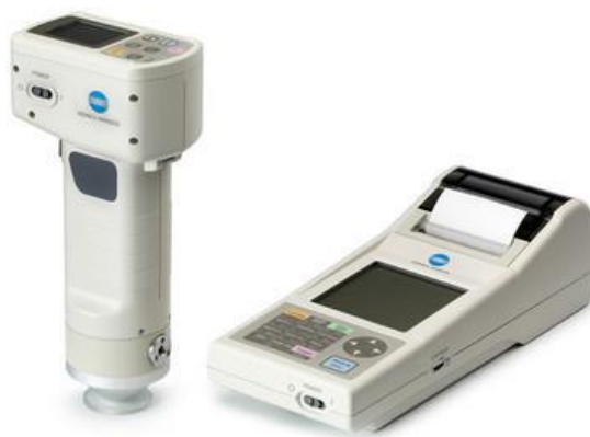
Slika 10 Kromametar Konica Minolta CR-400
