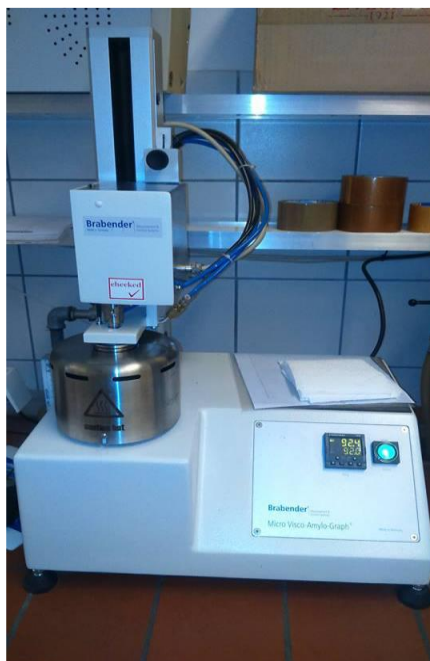
Slika 11 Brabenderov Mikro-visko amilograf
