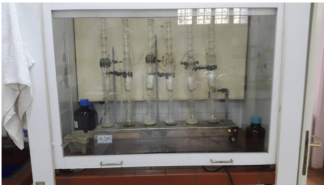
Slika 5 Ekstrakcija ulja po Soxhletu
