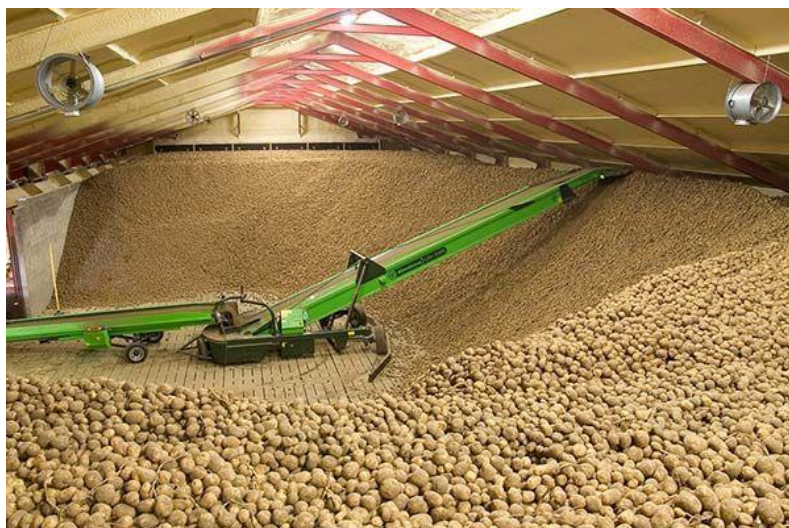
Slika 8 Skladište krumpira s aktivnom ventilacijom
