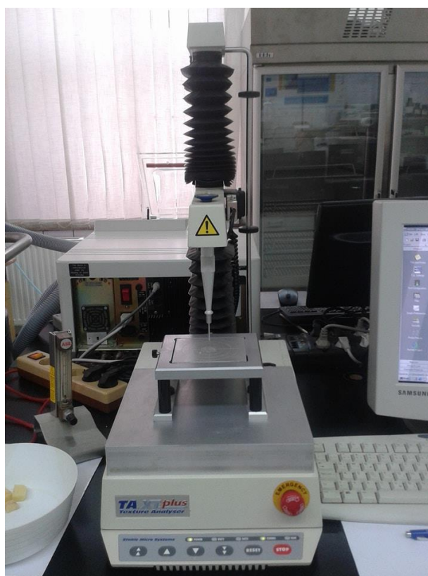
Slika 15 Teksturometar TA.XT (Stable Micro System, Velika Britanija)
