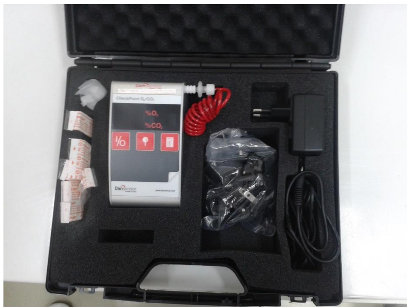
Slika 16 Uređaj za mjerenje koncentracije O 2 i CO 2 (Checkpoint, Dansensor, Danska)
