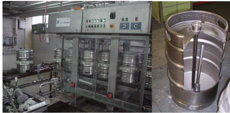
Slika 28 Punjenje pivskih ( keg ) bačava i presjek pivske ( keg ) bačve (web 1)
