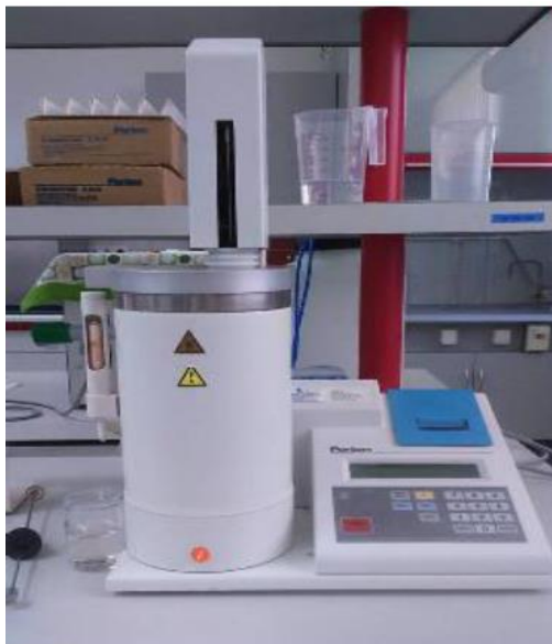
Slika 10 Uređaj po Hagbergu za određivanje broja padanja
