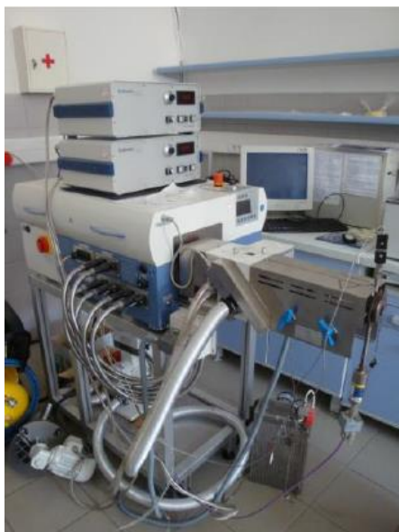
Slika 7 Laboratorijski jednopolžni ekstruder Brabender 19/20 DN
