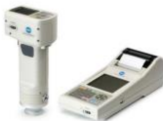
Slika 4 Kromametar Konica Minolta CR-400 (Jozinović, 2015)
