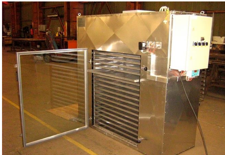
Slika 2 Uređaj za sušenje tjestenine (Web 1)
