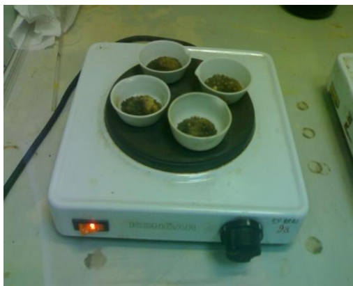
Slika 7 Predspaljivanje na grijaćoj ploči
