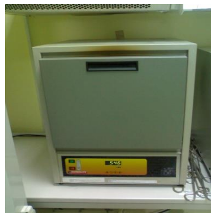
Slika 8 Žarenje u mufolnoj peći
