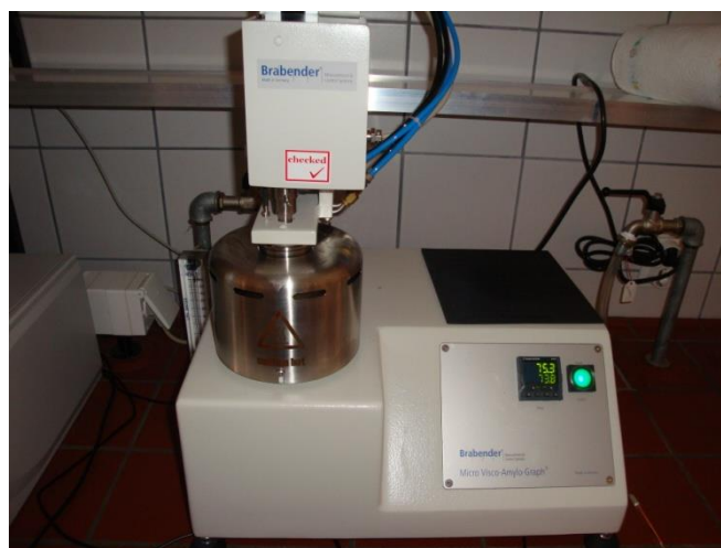
Slika 10 Brabenderov Mikro visko-analyzer (Jozinović, 2011.)
