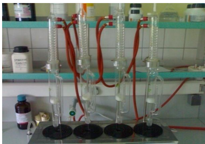
Slika 9 Aparatura za ekstrakciju masti po Soxhletu (Jozinović, 2011.)
