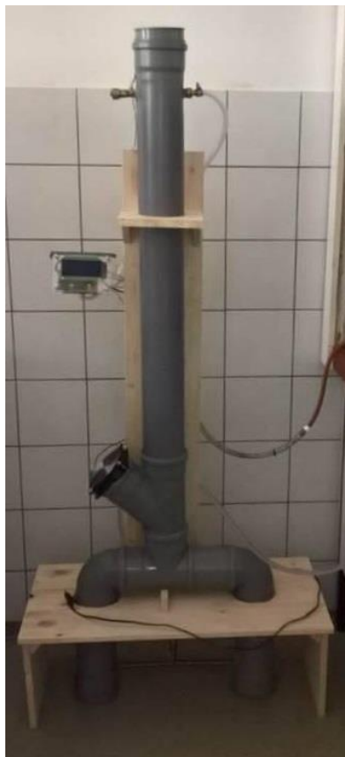
Slika 10 Rashladni toranj za kojeg je izveden sustav automatskog upravljanja
