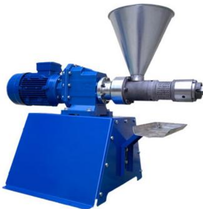
Slika 6 Laboratorijska kontinuirana pužna preša proizvođača ElektroMotor – Šimon d. o. o.
