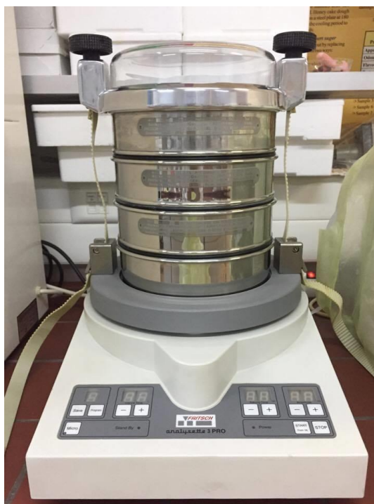
Slika 9 Laboratorijska tresilica s vibrirajućim sitima (Analysette 3 PRO, Fritsch)
