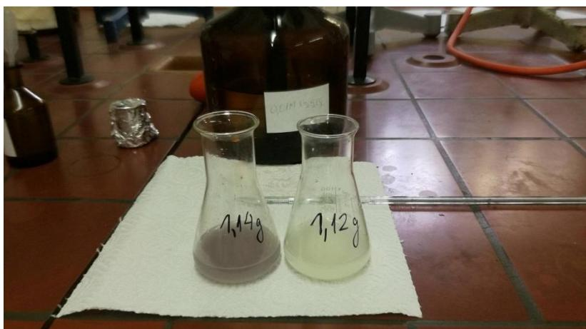
**Slika 6** Određivanje Pbr u uzorcima ulja
