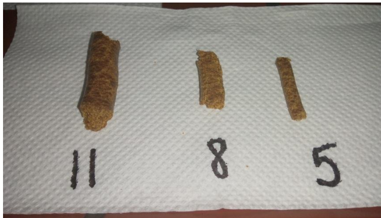
Slika 18 Veličina pogače ovisno o promjeru otvora glave preše a) 11 mm, b) 8 mm, c) 5 mm
